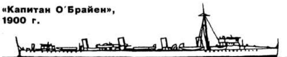
300-320 т, 64,9-65,5x6,5x1,8 м. ПМ - 2, 2 ПК. 6250 л.с. = 30 уз., 90 туг. Эж. 65 чел. 1 - 76 мм, 5-57 мм, 2 ТА 457 мм надв.
