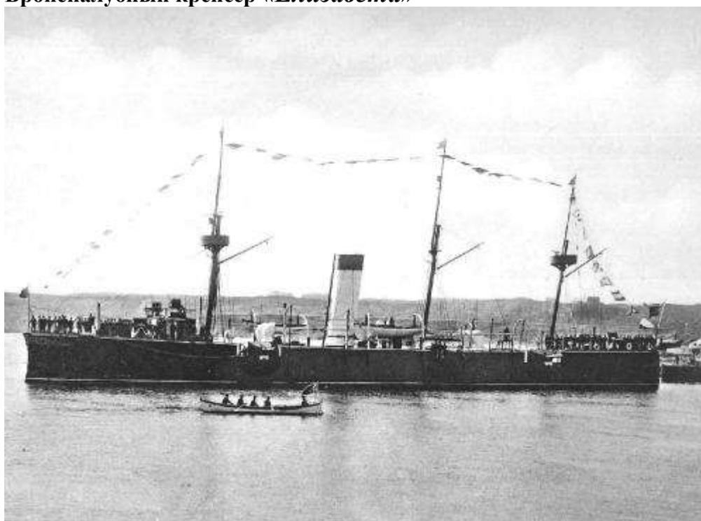
1320 т, 73х10,21х3,66 м. ПМ-2, 4700 л.с. = 17 уз., 80/300 т уг. Броня: палуба 87 — 50 мм. Эк. 190 чел. 4—120 мм, 4 — 76 мм, 2 — 37 мм, 4 ТА 356 мм.
