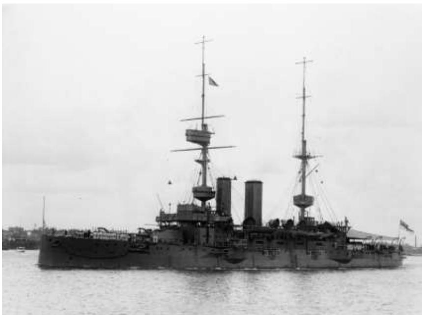
Водоизмещение 14500 т; размеры 131,6 х 22,9 х 7,9 м.
