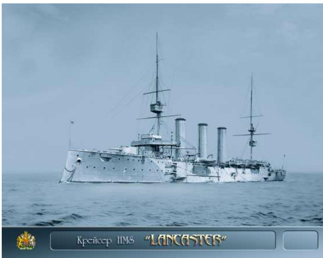
Водоизмещение 9956 т; размеры 141,27 х 20,12 х х 7,62 м.
