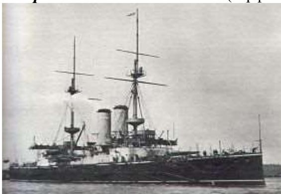
Водоизмещение 13600 т; размеры 132 х 23 х 7,9 м.
