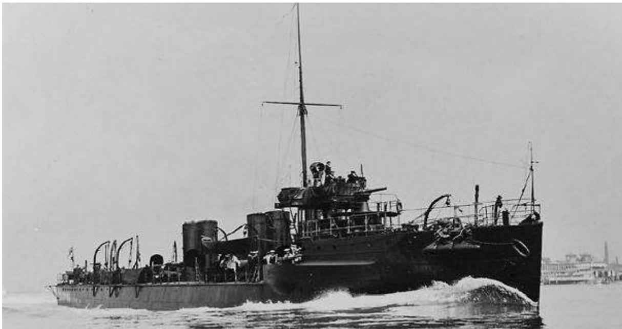
550-590/615-660 т, 71,2х7,2х2,9 м («Эрне»), 68,6х7,3х2,8 м (-Кеннет»), 68,6х7,2х2,7 м («Тест»). ПМ - 2 («Стур» и «Тест») ПТ-2, «Эден» ПТ-3). 7000 л.с. = 25,5 уз. 132т. уг. Эк. 70 чел. 1 -76мм, 5- 57мм, 2 ТА 457 мм.
