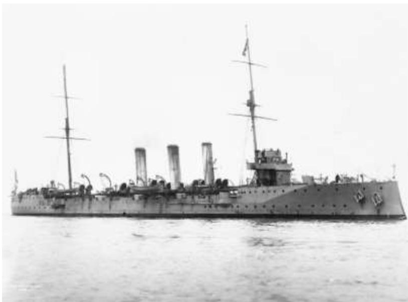
Водоизмещение 3048 т; размеры 113,92 x 12,19 x 4,42 м.
