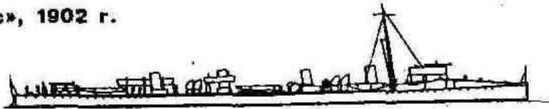
Модификация кораблей «30-узлового» типа. Построены в 1900-1903 гг. Еще два турбинных эсминца этой же серии - «Вайпер» и «Кобра» - погибли в результате аварий в 1901 г.
