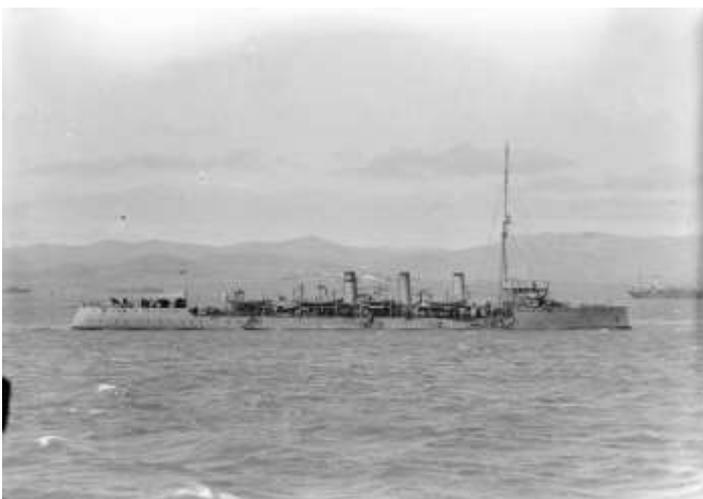
2860 т полн. («Эдвенчер» и «Эттентив» — 2640 т), 115,5x11,9x4,3 м. ПТ - 2, 12 ПК. 16500 л.с = 25 уз. 410 — 600 т уг. Броня: палуба до 28 — 50 мм. Эк. 268 чел. 10-76, 8 — 57 мм, 2 ТА 457 мм надв.
