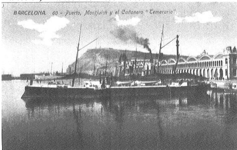
562 т, 58х6,73х3,15 м. ПМ - 2, 4 ПК, 2600 л.с.=19 уз. 106/130 т уг. Эк. 91 чел. 2—120 мм, 4—57 мм, 1 — 25 мм, 2 ТА.
