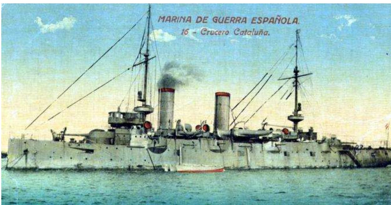
Водоизмещение 6888—7400 т; размеры 110,97 x 18,6 x 6,6 м.
