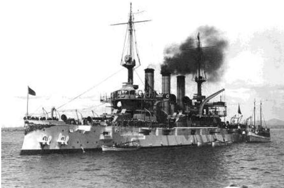
Водоизмещение 17650 т; размеры 139,1 x 23,4 x 7,5 м.
